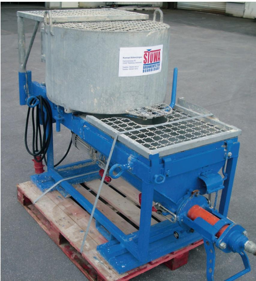
Abb. 7 Verpressung mittels Zwangsmischer und Exzentrerschneckenpumpe
