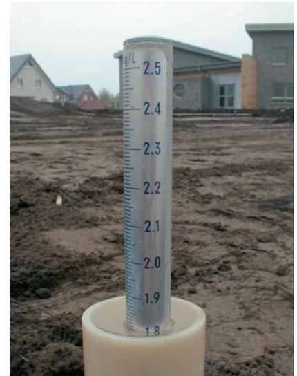
Abb. 6 Messung der Suspensionsdichte mittels Hydrometer
